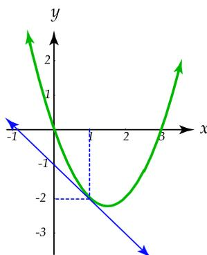
Figura 2.3: Recta tangente a  $f(x) = x^2 - 3x$ , en el punto  $(1, -2)$
