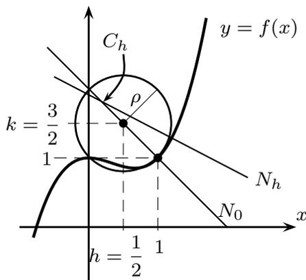
Figura 6.2: El círculo de curvatura para la curva  $f(x) = x^3 - x^2 + 1$  en  $x_0 = 1$
