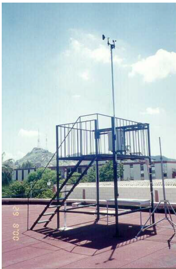
Figura 2-1. Estación solarimétrica de la Universidad de Sonora
