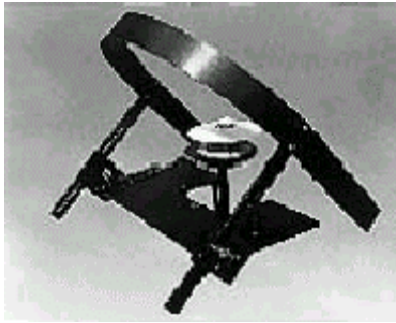
Figura 5-3. Piranómetro con anillo para medir la radiación difusa
